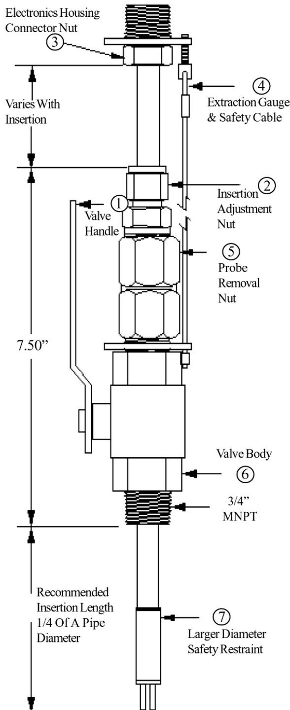
VERSA-SWITCH<sup>®</sup> and microtuf<sup>®</sup> Switch Option
